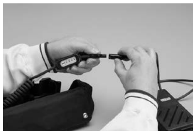
Abb. 8: Laden der AirBelt-Batterie
