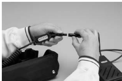
Figura 8: Ricarica della batteria dell'AirBelt
