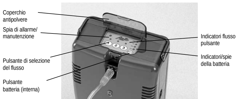
Figura 11: Primo piano del display della tastiera/allarmi
