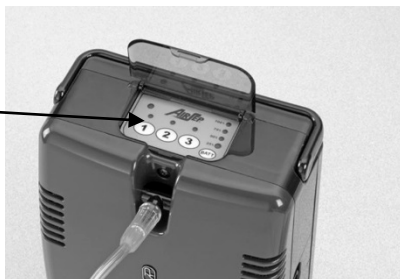
Figura 25: Indicatore di ispezione/manutenzione necessaria
