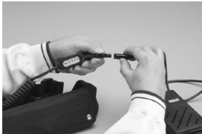
**Abb. 8: Laden der AirBelt-Batterie**
