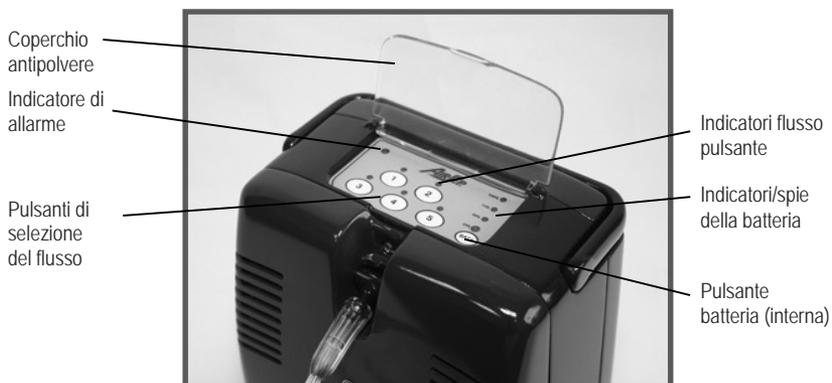
**Figura 12: Primo piano del display della tastiera/allarmi**
