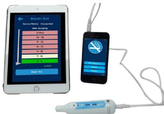
An ein Smartphone anschliessbares Überwachungsgerät zur Messung des Kohlenmonoxidgehalts in der Atemluft.
