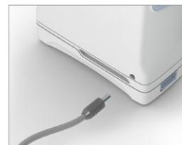
**ATTENZIONE** Assicurarsi che l'alimentatore si trovi in una sede ben ventilata in quanto fa affidamento sulla circolazione dell'aria per la dissipazione del calore. L'alimentatore potrebbe surriscaldarsi durante le operazioni. Assicurarsi che l'alimentatore di rete si sia raffreddato prima di maneggiarlo.
