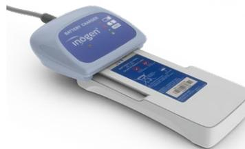
**ATTENZIONE** Evitare di toccare i contatti elettrici incassati nel caricabatteria esterno. Se i contatti vengono danneggiati il funzionamento del caricabatteria può risultare compromesso.
