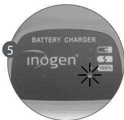
5. Lorsque les dispositifs sont correctement connectés, un voyant rouge fixe s'allume et indique que la batterie est en cours de chargement.
