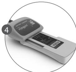
4. Connectez le chargeur de batterie externe en faisant glisser sur la batterie jusqu'à ce que vous entendiez un déclic et qu'il se bloque sur la batterie.
