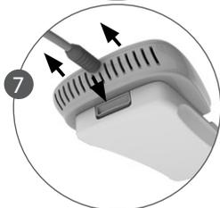
7. Premi il dispositivo di chiusura della batteria e disconnetti il caricabatterie dalla batteria.
