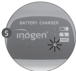
5. Sobald die Geräte ordnungsgemäß angeschlossen sind, leuchtet ein durchgehendes rotes Licht auf und zeigt an, dass der Akku geladen wird.
