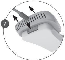
7. Drücken Sie die Akkuverriegelung nach unten und ziehen Sie das Ladegerät vom Akku ab.
