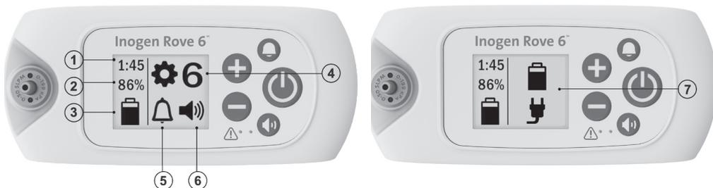
**1. Icône d'état de la batterie n° 1 :** indique approximativement le temps restant de charge actuelle de la batterie au réglage du débit actuel, indiqué en heures et minutes
