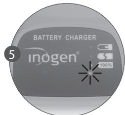
5. Lorsque les dispositifs sont correctement connectés, un voyant rouge fixe s'allume et indique que la batterie est en cours de chargement.
