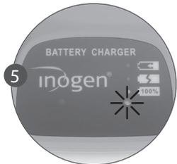
5. Una volta collegati correttamente i dispositivi, una luce rossa fissa si accende e indica che la batteria è in carica.
