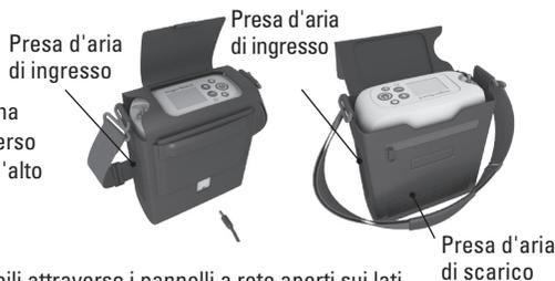
**IMPORTANTE:** assicurati che entrambe le prese d'aria siano visibili attraverso i pannelli a rete aperti sui lati della borsa, e che i fori di scarico dell'aria siano visibili dal pannello a rete aperto sulla parte anteriore della borsa.
