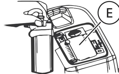
4. Lever et retirer l'adaptateur **D** du flacon de l'humidificateur (près du filtre d'entrée).
